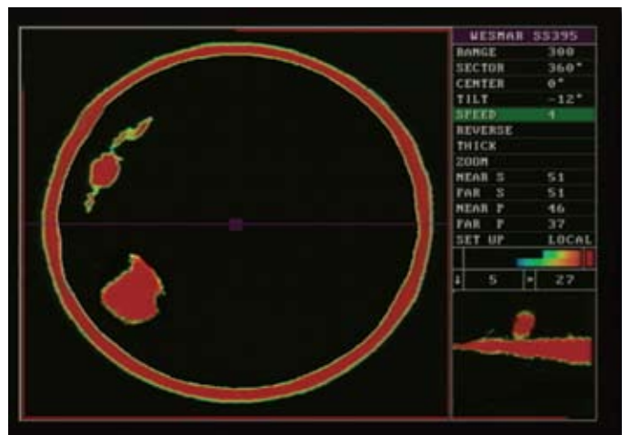
Прибор SS395 в режиме кругового обзора донной области. Режим плотности демонстрирует толщину рыбы в левом нижнем окошке.
