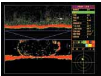
Dos vistas: Perfil de red de 360 grados y video sonda para monitoreo de pescado, relinga inferior y cambios de la red.
