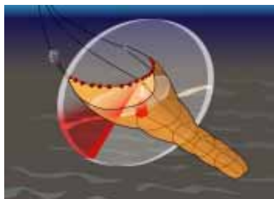
Dos vistas: Perfil de red de 360 grados y video sonda para monitoreo de pescado, relinga inferior y cambios de la red.
